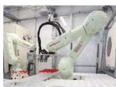
開栓分注工程 約10分
