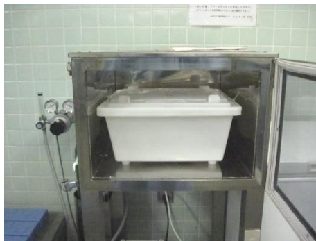
炭酸ガス安楽死装置に移動/運搬用ボックスを入れたところ
