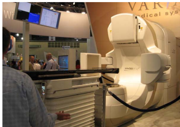
Fig. 8 V社の新しいリニアック 何と最高線量率は 2400MU/min
