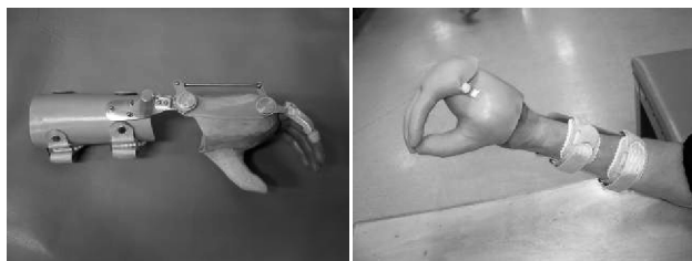
図1 把持装具の部品を使用した把持義手
