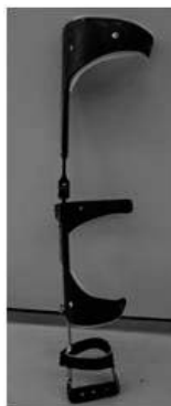
図3 試作3号 専用膝継手、膝当て固定にて800gとなる
