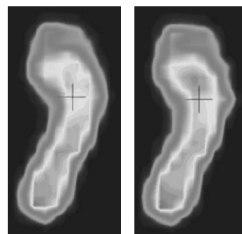
(1)原点位置 (2)Z方向に5mm上昇 図3 パッド高さの違いによる足底圧分布の違い
