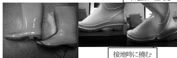
図2 長靴の加工 ヒールピッチの段差を削る
