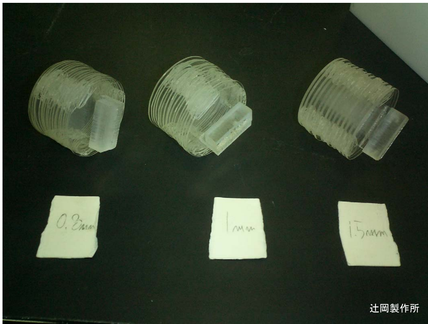
円盤タイプ: 左から0.8mm、1mm、1.5mmです。 円盤に加えて、スペーサーもアーチファクトを抑えるように円形になっています。
