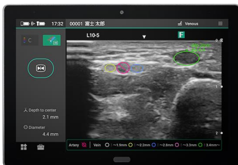
図 3-3. AI (artificial intelligence) 機能を開発、 搭載した携帯型エコー画像例
