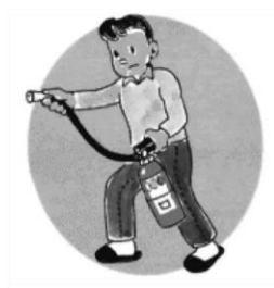
②ホースをはずし火元に向ける (ホースのないタイプの消火器の場合は、①の次に③へ)
