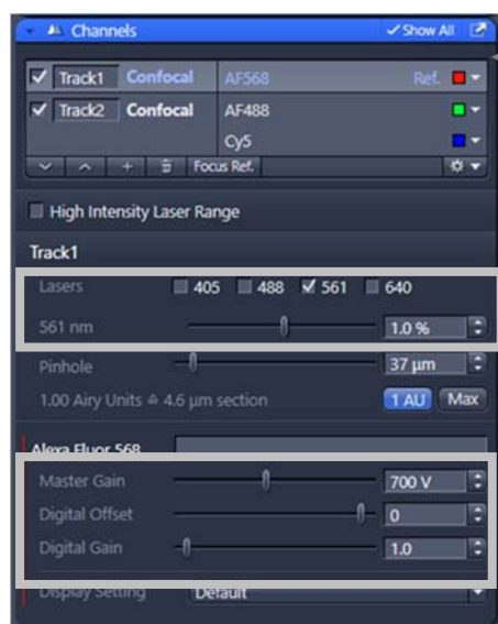
Fig.21 コントラスト調整画面 (LSM900 の場合)
